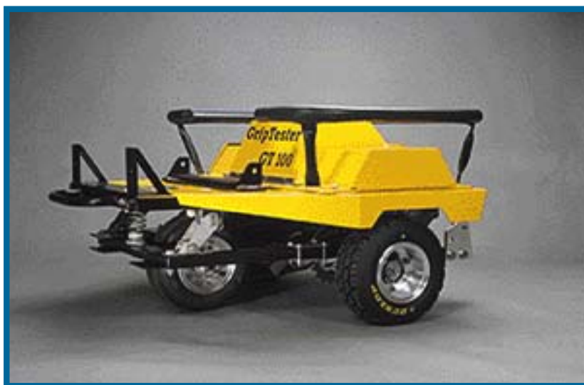
Equipamento GripTester utilizado na medição do Coeficiente de Atrito
